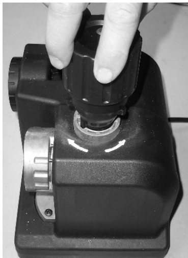
Рисунок 3. Схема встановлення та обробки свердла у відсіку для заточування задньої кута різальної поверхні.
