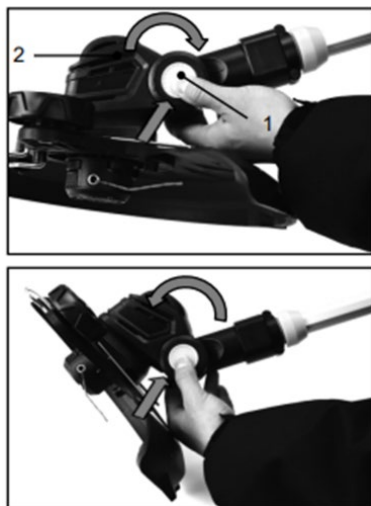
Рисунок 6. Схема регулювання кута нахилу різальної головки до поверхні газону. 1 – кнопка фіксації; 2 – напрямки регулювання.
