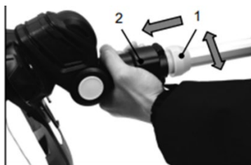
Рисунок 7. Схема регулювання різальної головки для звичайного скошування або підстригання краю газону. 1 – напрямки регулювання різальної головки; 2 – фіксатор різальної головки.
