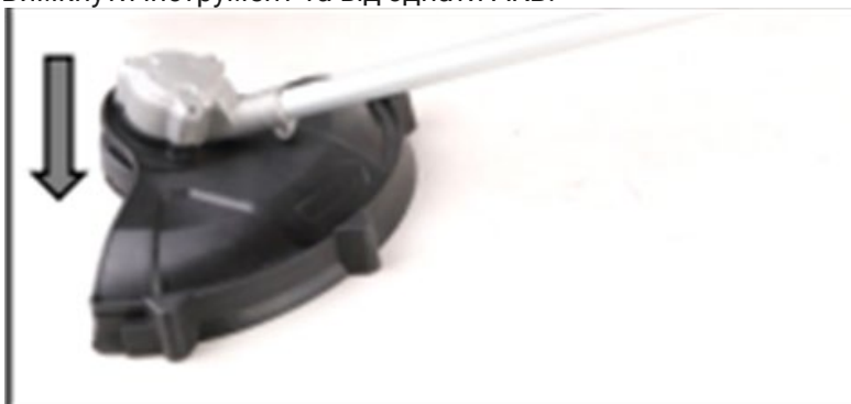
Рисунок 15. Схема перевірки механізму подачі жилки (стрілкою показаний напрямок руху головки під час роботи для збільшення робочих кінців жилки).
