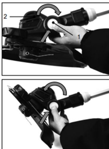
Рисунок 6. Схема регулювання кута нахилу різальної головки до поверхні газону.
