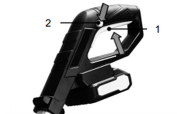
Рисунок 11. Схема пуску/зупинки виробу.
