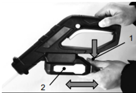
Рисунок 9. Схема встановлення/зняття акумуляторної батареї.
