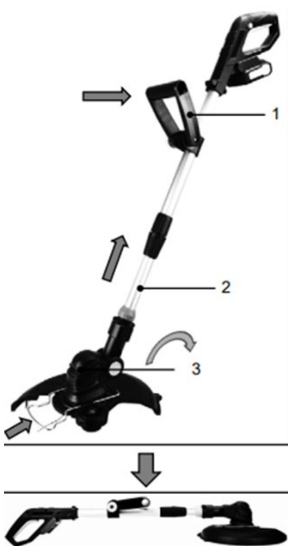
Рисунок 16. Схема складання виробу перед зберіганням.
