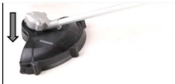
Рисунок 18. Схема перевірки механізму подачі жилки (стрілкою показаний напрямок руху головки під час роботи для збільшення робочих кінців жилки)
