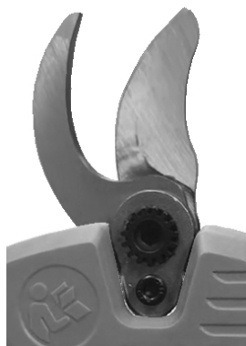
б) ножі в режимі вузького розкриття.
