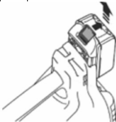
Рисунок 5. Схема встановлення/зняття АКБ.
