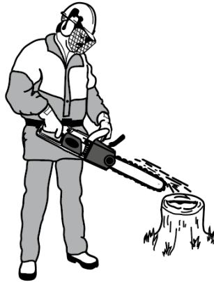
Рисунок. 11. Перевірка працездатності системи змащення напрямної та ланцюга
