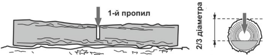
Рисунок 12. Схема попереднього розпилу колоди.
