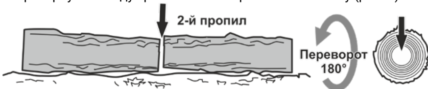
Рисунок 5. Схема остаточного розпилу колоди з протилежного боку.
