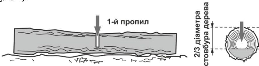
Рисунок 4. Схема попереднього розпилу колоди.
