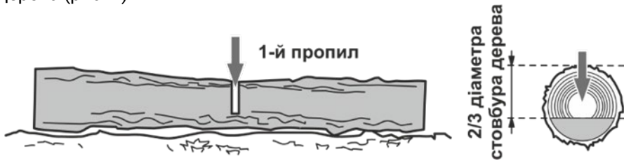
Рисунок 4. Схема попереднього розпилу колоди.
