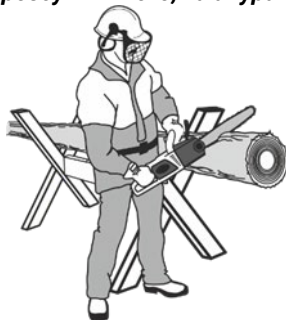
Рисунок 6. Схема розпилу колоди з використанням козлових опор.
