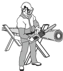
Рисунок 7. Схема розпилу колоди з використанням козлових опор.
