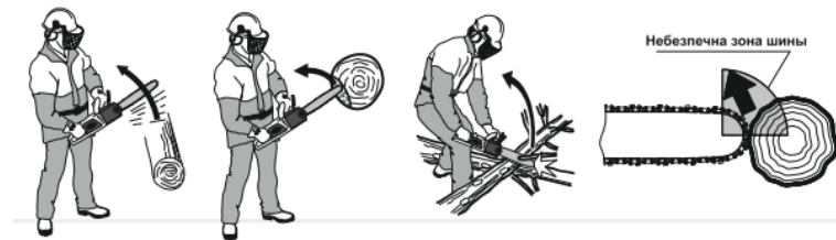
Рисунок 2. Приклади виникнення небезпечної віддачі виробу.
