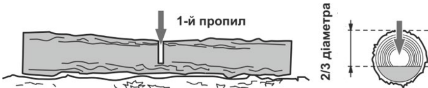
Рисунок 5. Схема попереднього розпилу колоди.
