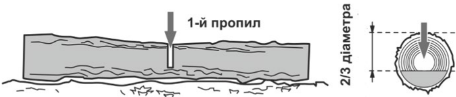
Рисунок 10. Схема попереднього розпи́лу колоди.
