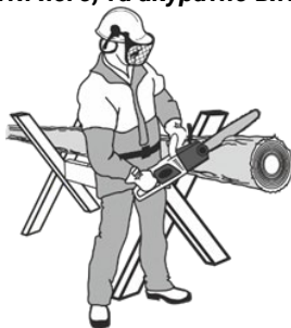
Рисунок 12. Схема розпилу колоди з використанням козлових опор.
