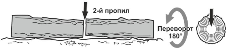
Рисунок 11. Схема остаточного розпи́лу колоди з протилежного боку.
