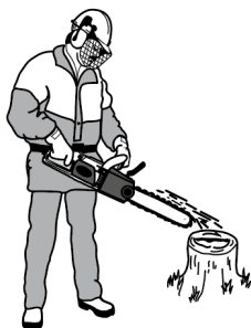
Рисунок. 9. Перевірка працездатності системи змащення напрямної та ланцюга.
