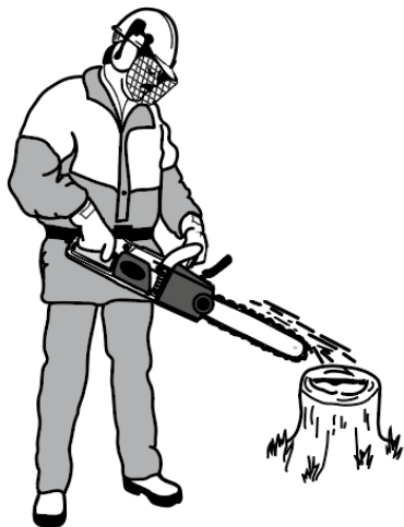
Рисунок. 12. Перевірка працездатності системи змащення напрямної та ланцюга.
