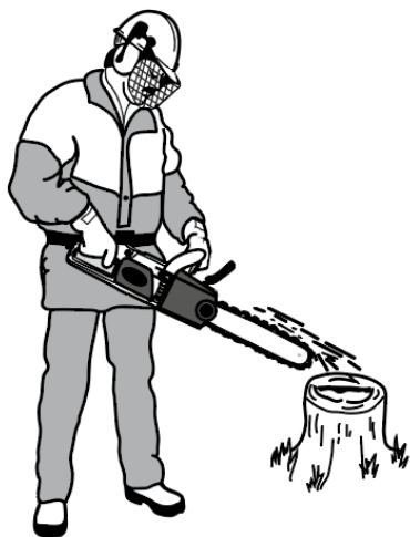
Рисунок. 12. Перевірка працездатності системи змащення напрямної та ланцюга.
