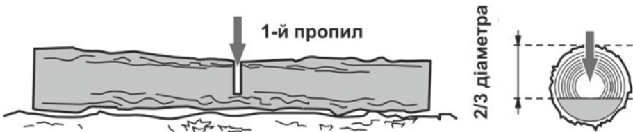
Рисунок 13. Схема попереднього розпилу колоди.
