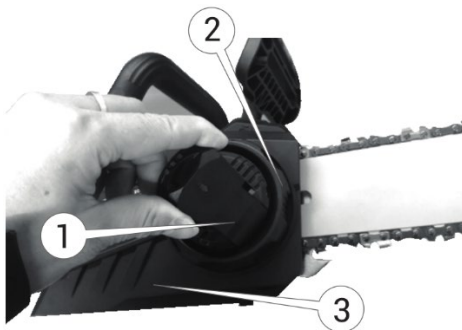
Рисунок 6. Схема вузла фіксації «шини» кришкою із механізмом натягу ланцюга.
