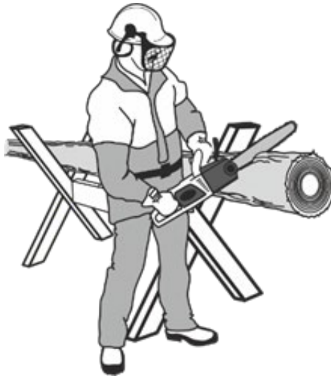
Рисунок 15. Схема розпили колоди з використанням козлових опор.
