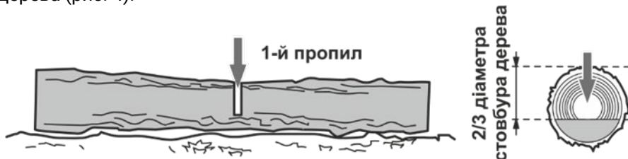
Рисунок 4. Схема попереднього розпили колоди.
