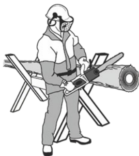
Рисунок 6. Схема розпили колоди з використанням козлових опор.
