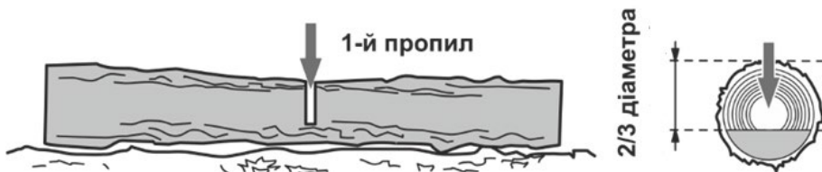
Рисунок 5. Схема попереднього розпилу колоди.
