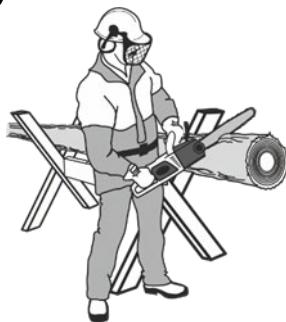
Рисунок 7. Схема розпилу колоди з використанням козлових опор.
