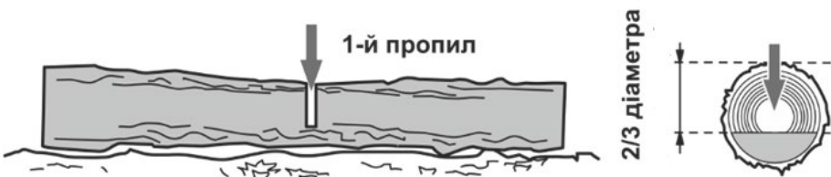
Рисунок 14. Схема попереднього розпи́лу колоди.
