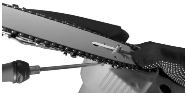
Рисунок 10. Регулювання натягу ланцюга.
