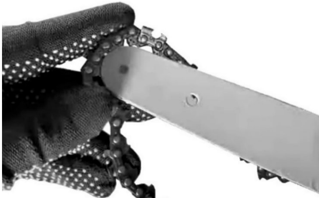
Рисунок 8. Введення ланцюга в зачеплення з веденою зірочкою на напрямній шині.
