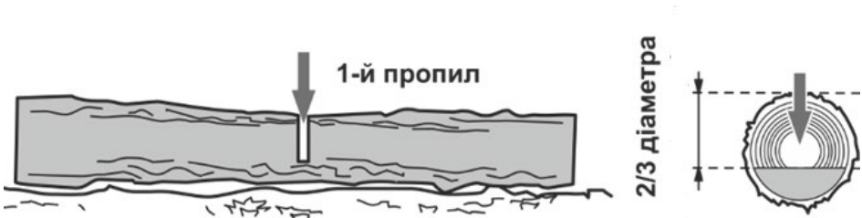
Рисунок 10. Схема попереднього розпилу колоди.
