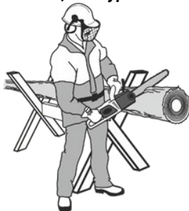
Рисунок 12. Схема розпилу колоди з використанням козових опор.
