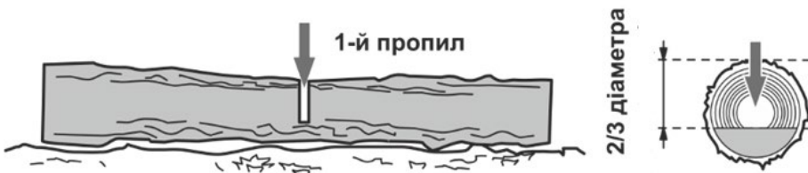
Рисунок 11. Схема попереднього розпилу колоди.
