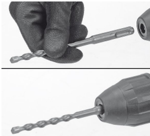
Рисунок 4. Схема встановлення/вилучення змінного кінцевого інструмента.
