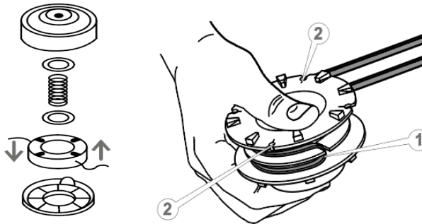
Рисунок 15. Схема заміни жилки у різальній головці.
