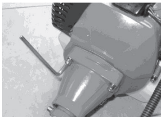
Рисунок 2. Схема складання стика «двигун-зчеплення» приводного блоку.
