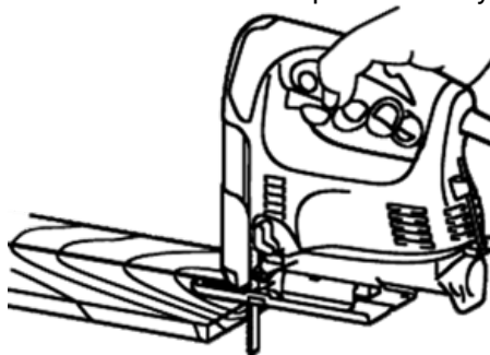
а) різання перпендикулярно поверхні заготовки
