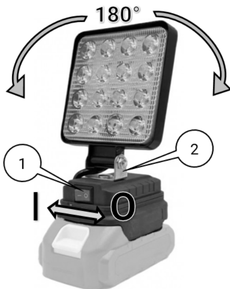
Рисунок 5. Схема увімкнення ліхтаря та налаштування кута освітлення.
