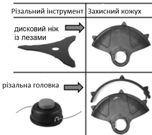
Рисунок 3. Комбінації використання різального інструменту із захисним кожухом.
