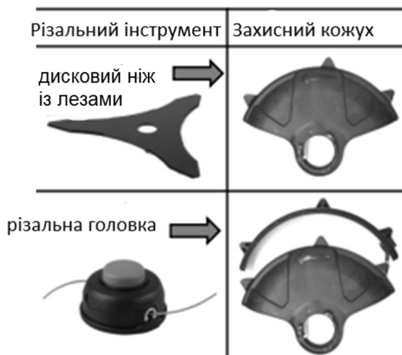
Рисунок 4. Комбінації використання різального інструменту із захисним кожухом.
