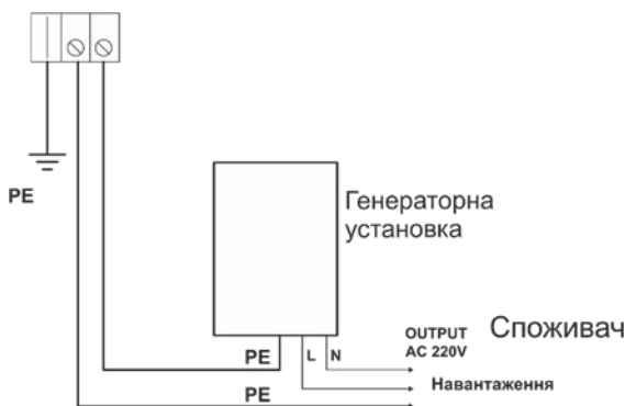
Рисунок 8. Схема заземлення виробу.
