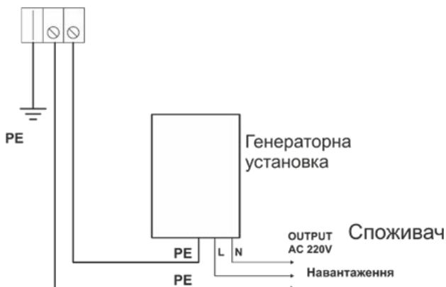
Рисунок 4. Схема заземлення виробу.
