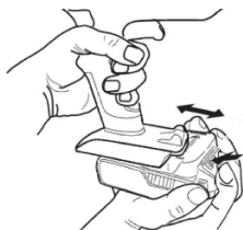
Рисунок 7. Схема встановлення акумуляторної батареї.
