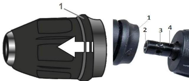
Рисунок 6. Схема роботи із робочими патронами кінцевих насадок.
