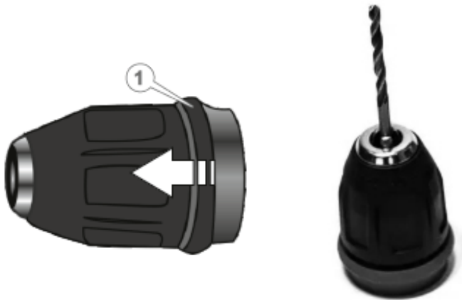
Рисунок 5. Схема демонтажа свердлильного патрона.
