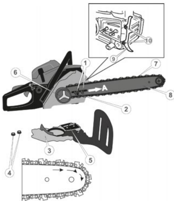
Рисунок 3. Схема встановлення шини із різальним ланцюгом.
