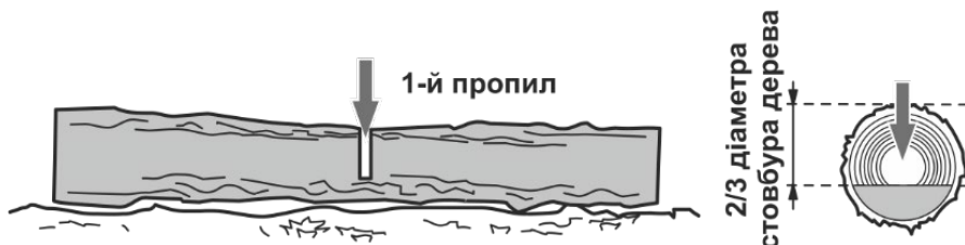
Рисунок 13. Схема попереднього розпили колоди.
