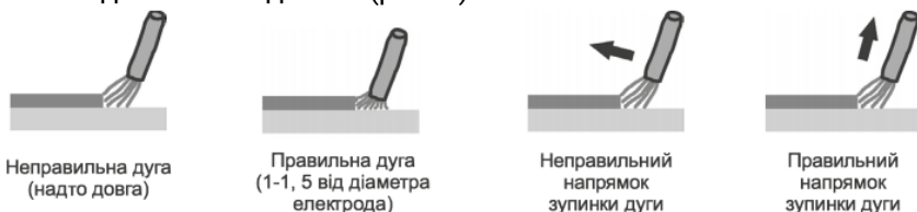
Рисунок 4. Відстань розташування електрода із покриттям до деталі під час ручного дугового зварювання («ММА»).
