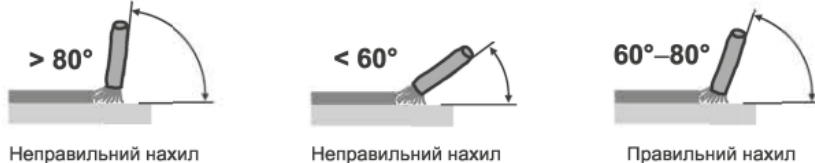
Рисунок 5. Кут розташування електрода із покриттям до деталі під час ручного дугового зварювання («ММА»).
