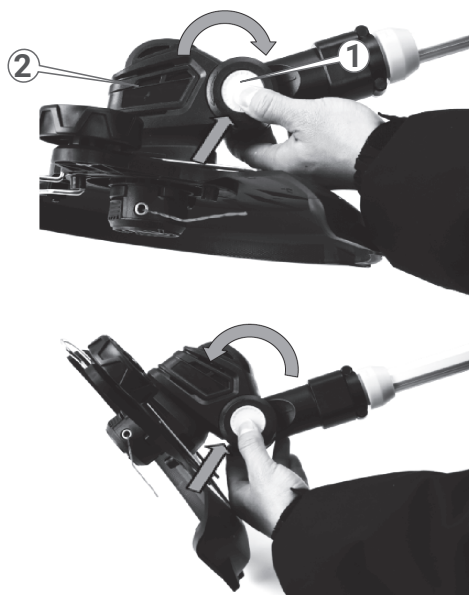
Рисунок 7. Схема регулювання кута нахилу різальної головки у вертикальній площині.
