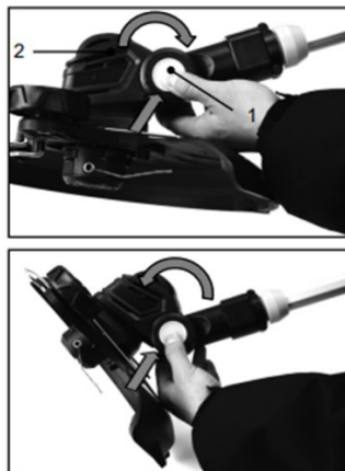
Рисунок 6. Схема регулювання кута нахилу різальної головки до поверхні газона.
