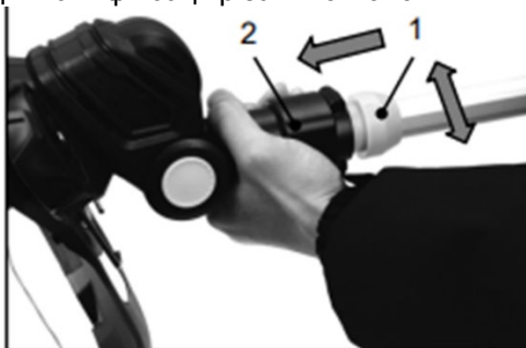
Рисунок 8. Схема регулювання різальної головки для звичайного скошування або підстригання краю газона.
