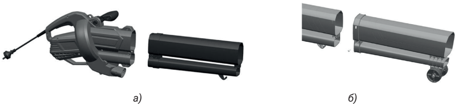
Рисунок 2. Схема підготовки повітряного тракту виробу до роботи.
