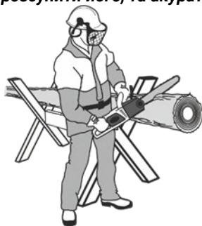
Рисунок 7. Схема розпили колоди з використанням козових опор.
