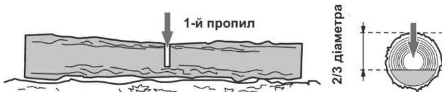
Рисунок 5. Схема попереднього розпи́лу колоди.
