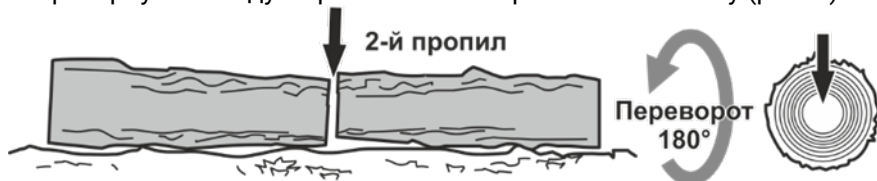
Рисунок 6. Схема остаточного розпи́лу колоди з протилежного боку.
