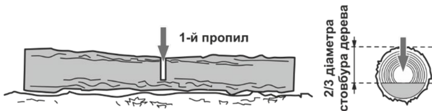
Рисунок 4. Схема попереднього розпи́лу колоди.
