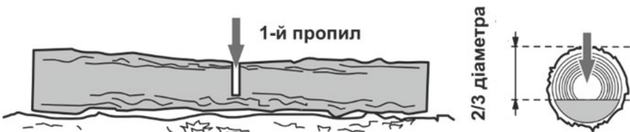
Рисунок 12. Схема попереднього розпи́лу колоди.
