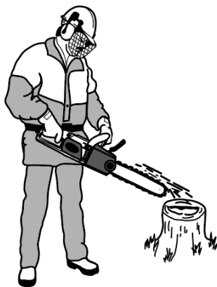
Рисунок. 11. Перевiрка працездатностi системи змащення напрямної та ланцюга
