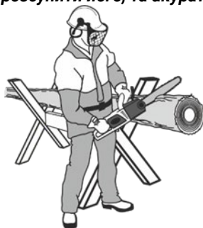
Рисунок 14. Схема розпили колоди з використанням козлових опор.
