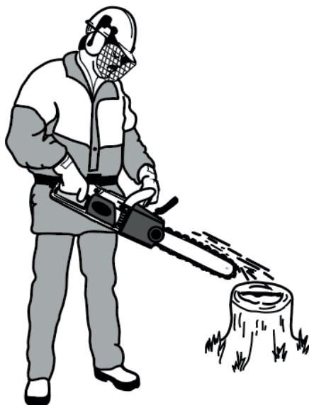
Рисунок. 7. Перевірка працездатності системи змащення напрямної та ланцюга.
