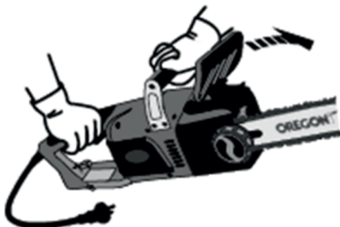
Рисунок 8. Перевірка працездатності аварійного гальма ланцюга.
