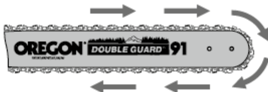
Рисунок 4. Розташування ланцюга на напрямній шині.
