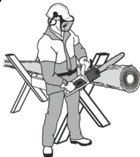
Рисунок 7. Схема розпилу колоди з використанням козлових опор.
