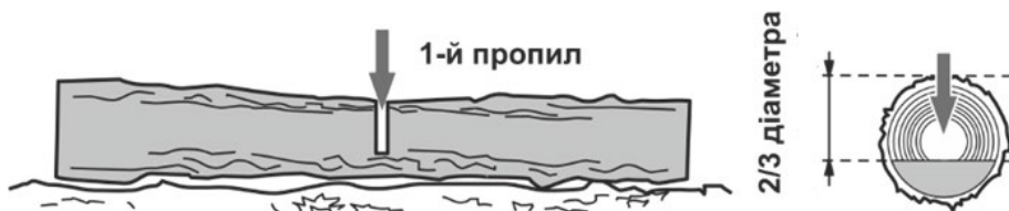
Рисунок 5. Схема попереднього розпи́лу колоди.
