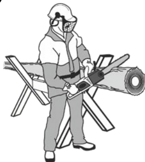
Рисунок 7. Схема розпилу колоди з використанням козлових опор.
