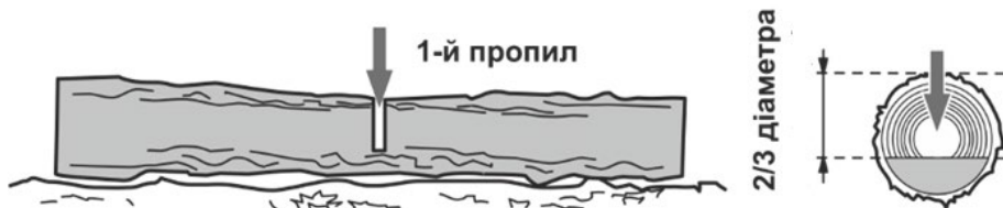
Рисунок 5. Схема попереднього розпи́лу колоди.
