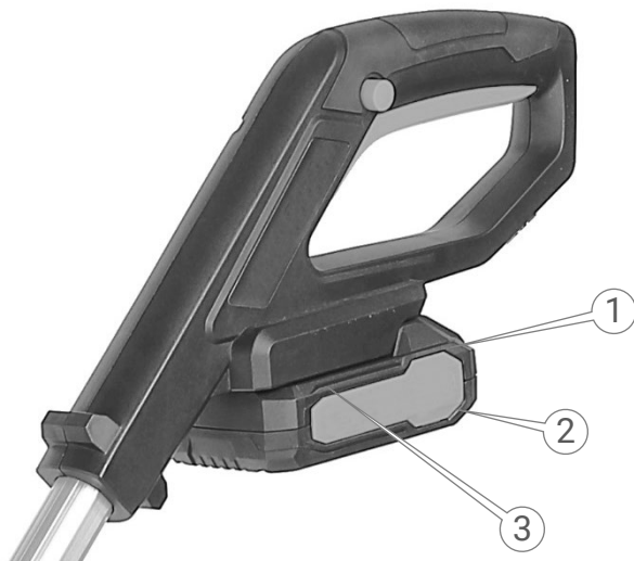
Рисунок 7. Схема під'єднання та від'єднання акумуляторної батареї.
