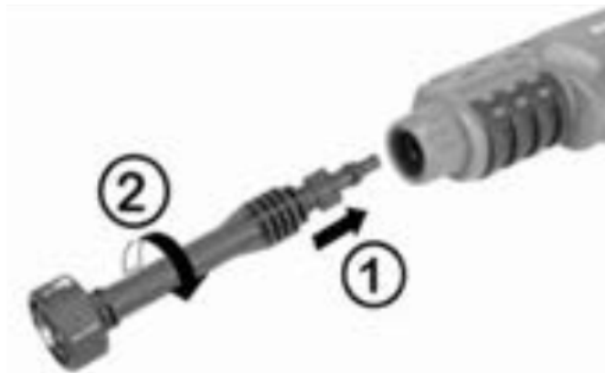
Рисунок 2. Схема під'єднання багатофункціональної форсунки-розпилювача «6 в 1» до виробу.
