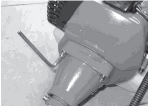
Рисунок 2. Схема приєднання стикувального вузла до двигуна виробу.
