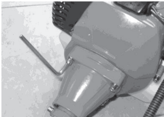
Рисунок 2. Схема приєднання стикувального вузла до двигуна виробу.
