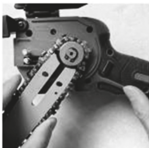
2б) встановлення різального блоку на виріб
