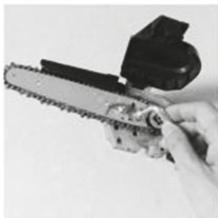
2в) фіксація різального блоку на виробі
