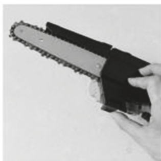
2г) фіксація захисної кришки над різальним блоком
