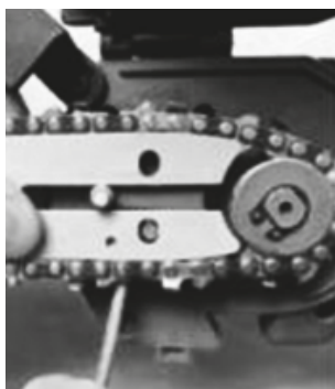
Рисунок 4. Схема перевірки натягу ланцюга.
