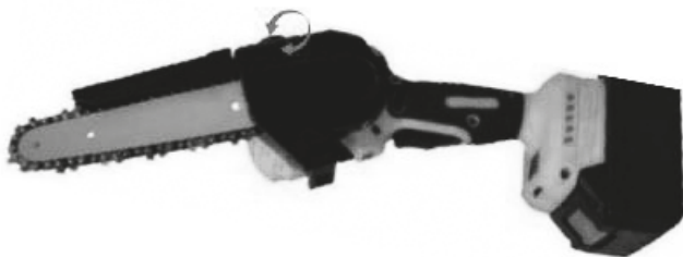
Рисунок 3. Схема заправки мастилом системи змащування виробу.
