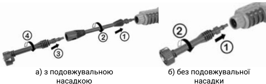
Рисунок 2. Схема під'єднання багатофункціональної форсунки-розпилювача «6 в 1» до виробу.
