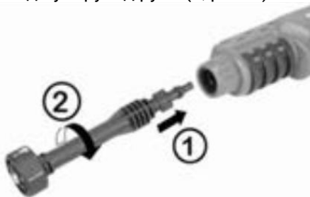
Рисунок 2. Схема під'єднання багатофункціональної форсунки-розпилювача «6 в 1» до виробу.
