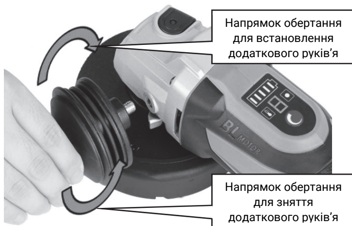
Рисунок 6. Встановлення та зняття додаткового руків'я.
