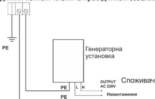
Рисунок 6. Схема заземлення виробу.
