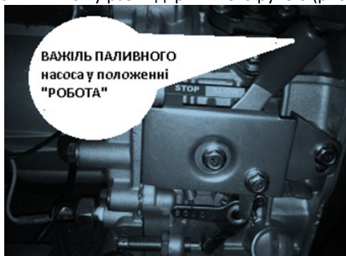
Рисунок 5. Важіль режиму паливного насоса в положенні «РОБОТА».
